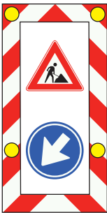
Actierek aan linkerzijde voorbijgaan; Wegwerkzaam- heden
